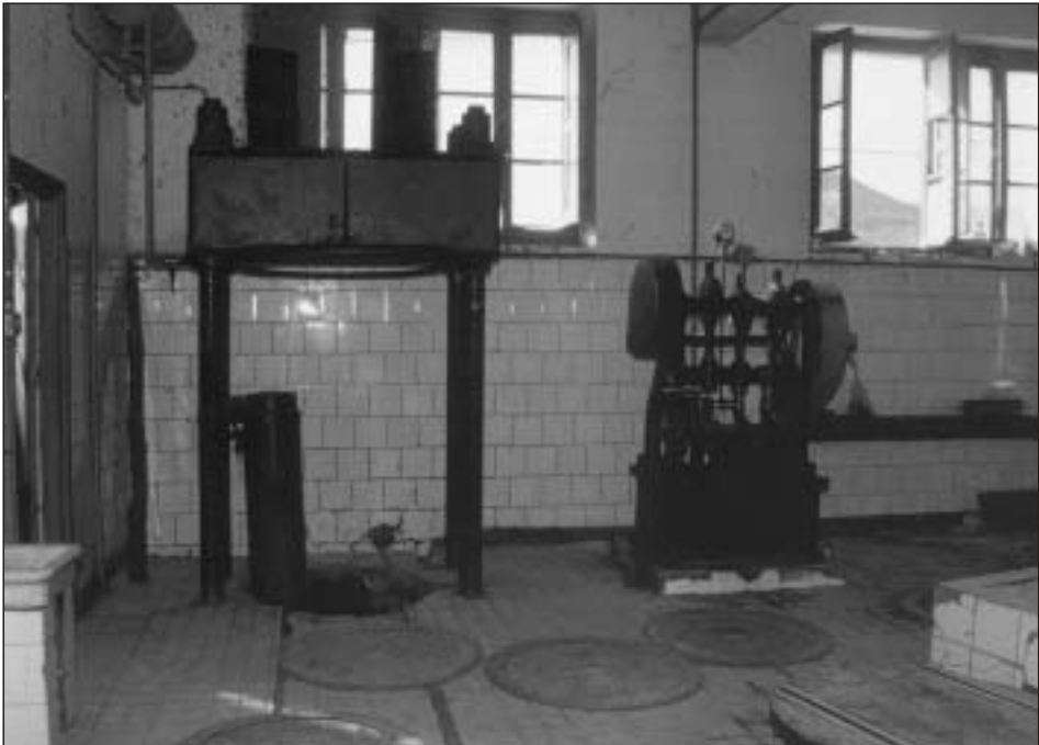
Interior del trujal electrificado de Sada, donde se aprecia la prensa hidráulica con la bomba para su puesta en funcionamiento
